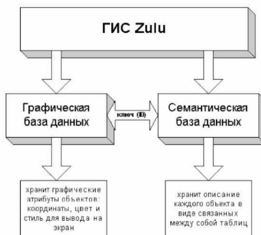
Рисунок 9.1. Структурная схема представления информации в системе Zulu
